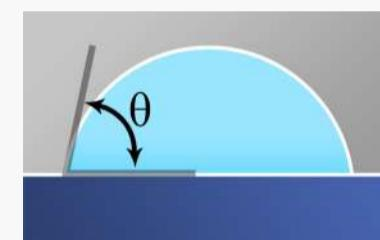
اگر در هنگام اندازه‌گیری، خط تماس در حال حرکت باشد، زاویه تماس اندازه‌گیری شده از نوع دینامیکی و در غیر این صورت از نوع استاتیک خواهد بود.
