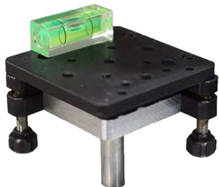
شما می‌توانید با تراز کردن نگه‌دارنده نمونه، بر روی نمونه‌های ناهموار یک قسمت افقی برای انجام تست پیدا کنید.
