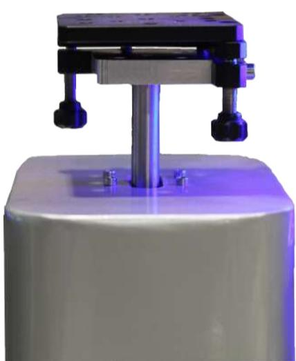
حرکت دوربین و نگه‌دارنده نمونه در محور Z به شما این امکان را می‌دهد تا نمونه‌های با ارتفاع ۰ تا ۳۰ میلی‌متر را آزمایش کنید. ارتفاع دوربین و استیج تنها با یک کلیک قابل تنظیم هستند. همچنین شما می‌توانید با این ویژگی تست Pendant Drop را به راحتی انجام دهید. حرکت دوربین در راستای X باعث می‌شود فوکوس دوربین به راحتی قابل تنظیم باشد. همچنین با حرکت نگه‌دارنده نمونه در راستای Y می‌توان تنها با یک کلیک، اندازه‌گیری را در نقاط مختلف نمونه تکرار کرد.
