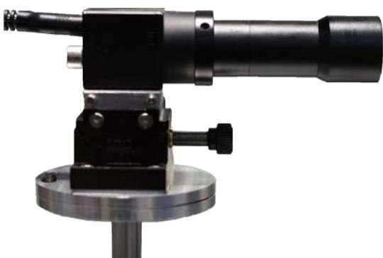
این ویژگی این امکان را به شما می‌دهد تا بتوانید بازتاب قطره را ببینید و زاویه تماس را دقیق محاسبه کنید. همچنین انعکاس قطره روی سطح برای تشخیص خودکار زاویه تماس لازم است. استفاده از این مکانیزم به علت پدیدار کردن خط تماس، لازمه اندازه‌گیری دقیق زاویه تماس است.
