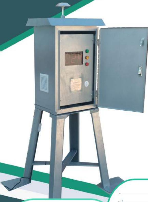
دستگاه پایش ایستگاهی آلاینده های هوای محیط (SAPA) جهت اندازه گیری آلاینده های هوای شهری از جمله ذرات معلق با قطر کمتر از ۱۰ میکرومتر (PM10) و کمتر از ۲.۵ میکرومتر (PM2.5) و همچنین گاز های آلاینده ای ازون (O3)، کربن مونواکسید (CO)، نیتروژن دی اکسید (NO2) و گوگرد دی اکسید (SO2) به کار می رود.
