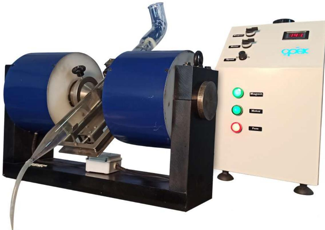
لوله دیویس ابزاری آزمایشگاهی به منظور تفکیک نمونه های معدنی به ذراتی با قدرت مغناطیسی مختلف می باشد. این تجهیز برای جداسازی سنگ های معدنی با شدت مغناطیسی کم نیز قابل استفاده می باشد. یکی از مهم ترین کاربردهای این دستگاه جهت بررسی میزان درصد آهن و اکسید آهن در سنگ های معدنی می باشد.
