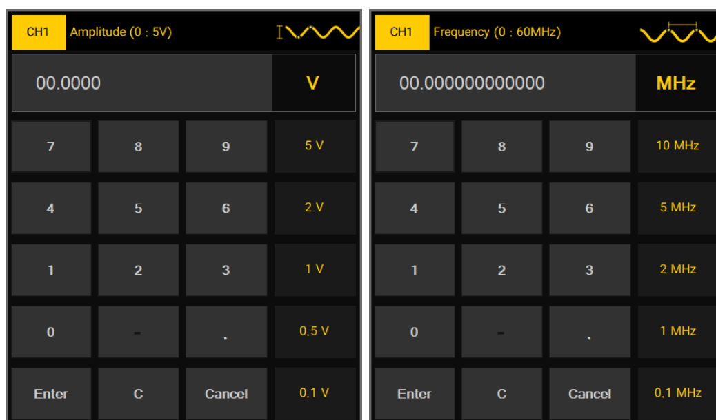
شکل ۱۲ پنجره مقداردهی فرکانس و ولتاژ برای کانال ۱
