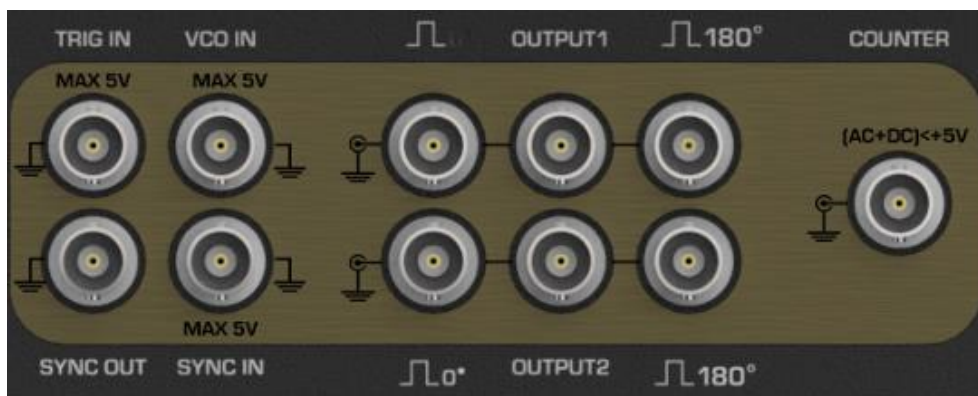
شکل ۶ کانکتورهای موجود در جلوی دستگاه SGC2818
