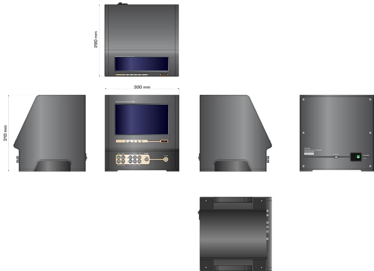
شکل ۱ ابعاد مکانیکی دستگاه SGC2818
