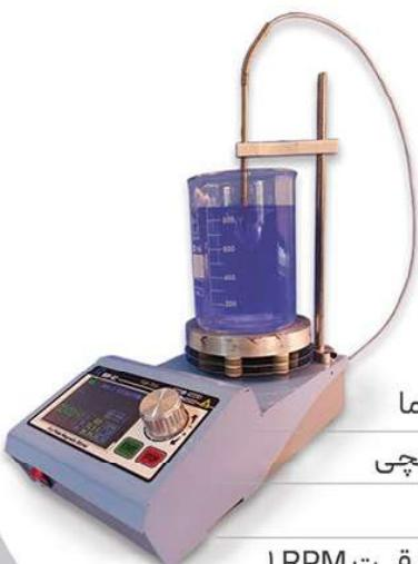
دارای مدار کنترل PID برای تنظیم دور و دما
