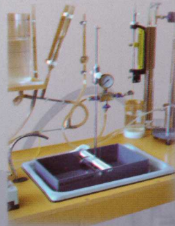
دستگاه ارتفاع متاستریک و مخزن مربوطه
