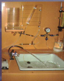
سیستم پمپاژ با دبی پایین در حال کار
