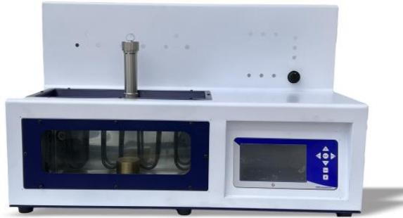
با استفاده از این نسبت می توان انواع محصولات هیدروکربنی از جمله روغن ها، سیالات هیدرولیک، سوخت، حلال ها و غیره را از نظر خوردگی به مس ازمایش کرد با توجه به اینکه که فشار بخار آنها از (۱۲۴ کیلو پاسکال) بیشتر نیستند.
