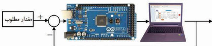
در این آزمایش، دانشجویان با استفاده از شبیه سازی سخت افزار در حلقه می توانند عملکرد سخت افزار کنترل کننده را اعتبارسنجی کنند. در این روش فرامین کنترلی با استفاده از ابزار تولید خودکار کد بر سخت افزار کنترل کننده پیاده سازی شده و به مدل سه درجه آزادی نرم افزاری چهارپره اعمال می شود. از این رو، به منظور اعتبارسنجی حلقه های کنترل کننده دانشجویان بهره های کنترل کننده را طوری تنظیم می کنند که نتایج آن با نتایج شبیه سازی نرم افزاری یکسان شود.
