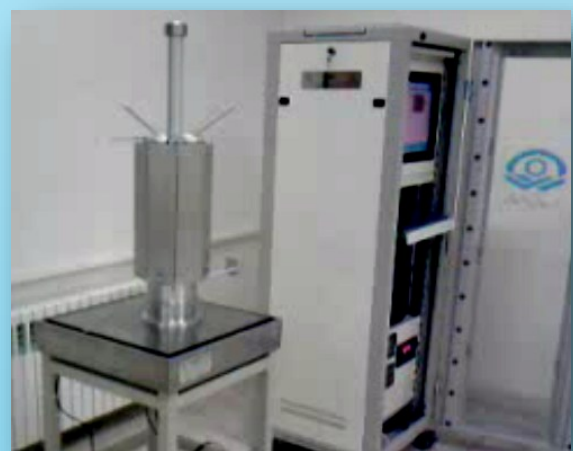
در حال اندازه‌گیری مختصات مرکز جرم مدل ماهواره رصد
