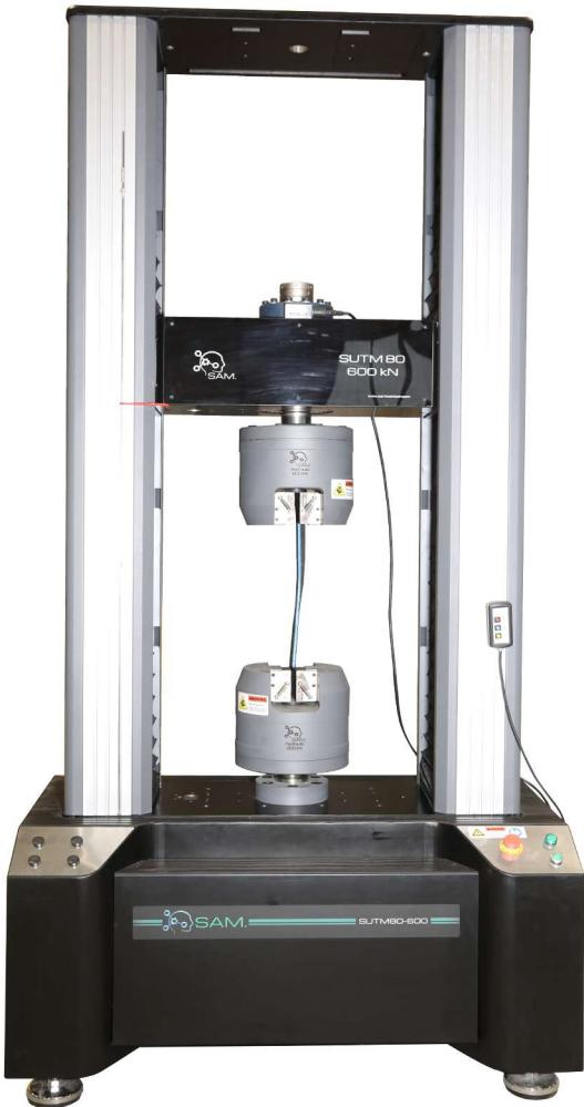
دستگاه های تست تنسایل یونیورسال سری 80 شرکت سانا اندیشه سازان مجد با کد فنی SUTM80 در ظرفیت های 100kN الی 1000kN به صورت دو ستون با سیستم حرکتی سرو دیجیتال و بال اسکرو توانایی انجام انواع آزمون های خواص مکانیکی مواد مطابق با استانداردهای بین المللی و با دقت و تکرار پذیری بسیار بالا را دارند.
