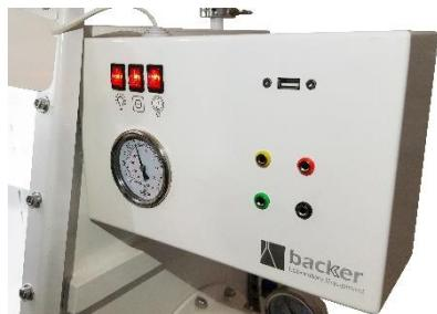
**مرحله ۵:** حال با استفاده از کلیدهای جعبه کنترل می توانید روشنایی دستگاه، پریز داخل محفظه گلاوباکس و پمپ خلاء را روشن و خاموش نمایید.
