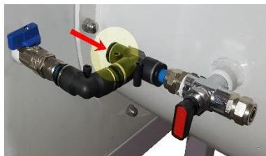
**مرحله ۲:** پمپ را به پریز پشت جعبه کنترل متصل کرده و شلنگ پنوماتیکی آنرا به اتصال نشان داده شده در شکل متصل نمایید. کلید روشن/خاموش موجود بر روی پمپ را در حالت روشن قرار دهید.
