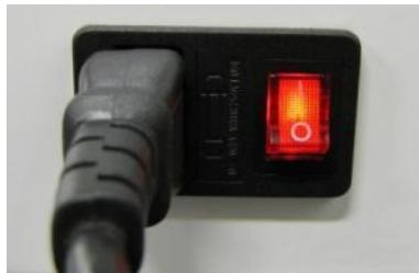
**مرحله ۱:** کابل تغذیه را به جعبه کنترل دستگاه متصل کرده و با استفاده از کلید روشن/خاموش، دستگاه را روشن نمایید. در صورت برقراری جریان برق، با روشن شدن دستگاه، چراغ روی کلید، روشن می‌شود.
