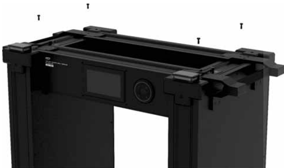
شکل ۸۴ بستن پیچ‌های بالایی جعبه‌ی نمایشگر و دوربین به چنل اصلی و جانبی
