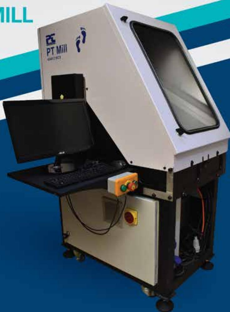
**| پیکربندی یا شاسی:** در طراحی دستگاه به دلیل دور بالای اسپیندل در زمان کار، از بدنه آلミニومی استفاده می شود تا بتواند نویز ها و ارتعاشات دستگاه را میرا کرده و لرزش دستگاه را کاهش دهد.
