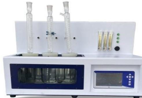
هدف از تست خوردگی ضدیخ ارزیابی اثربار مایعات خنک کننده موتور بر روی آزمونهای فلزی تحت شرایط کنترل شده آزمایشگاهی در ظروف سیسنه ای است.
