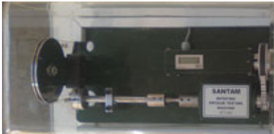
فک گیره ای با پیچ های محکم کننده و سیستم بارگذاری جهت جبران وزن فک
