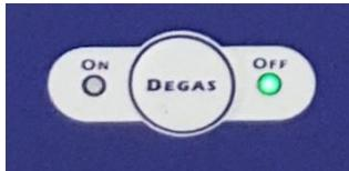
این صورت که دستگاه ۵ ثانیه کار می‌کند و ۲ ثانیه متوقف می‌شود. با این کار گاز موجود در محلول خارج شده و عمل شستشو بهتر انجام می‌شود. معمولاً ۵ دقیقه زمان برای این مرحله کافی است. با فشردن مجدد این کلید عمل گاز زدایی متوقف می‌شود.
