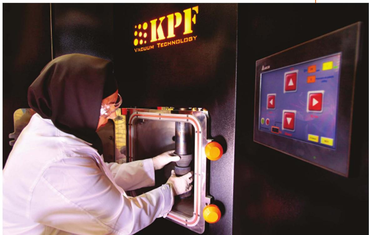
این دستگاه قابلیت انجام فرایندهای زینترینگ، اتصال (Bounding)، عملیات سطحی و ساخت انواع قطعات از مواد پیشرفته را دارد. زمینه های کاربردی دستگاه عبارتند از :
