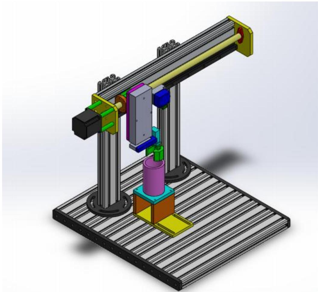
مجموعه فوق ترکیبی از بخش مکانیک و الکترونیک می باشد که هر دو بخش مستلزم مراقبت و نگهداری می باشد . در بخش مکانیک می باشد کلیه تجهیزات ( نظیر سیلندرها ، پروفیل ها ، ساپورتها و .... ) هر ماه از لحاظ عملکرد ، خوردگی ، زنگ زدگی و .... بررسی شوند . شلنگ های پنوماتیک ، فلو کنترلرها می باشد از لحاظ نشتی هوا بررسی شوند . در بخش الکترونیک نیز می باشد سنسورها ، موتورها ، شیربرقی ها از لحاظ اتصال به برد I/O بررسی شوند .
